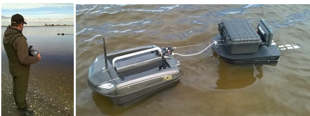
Sonar metingen onderwaterbodem door Waterdieptekaart Abbertstrand
